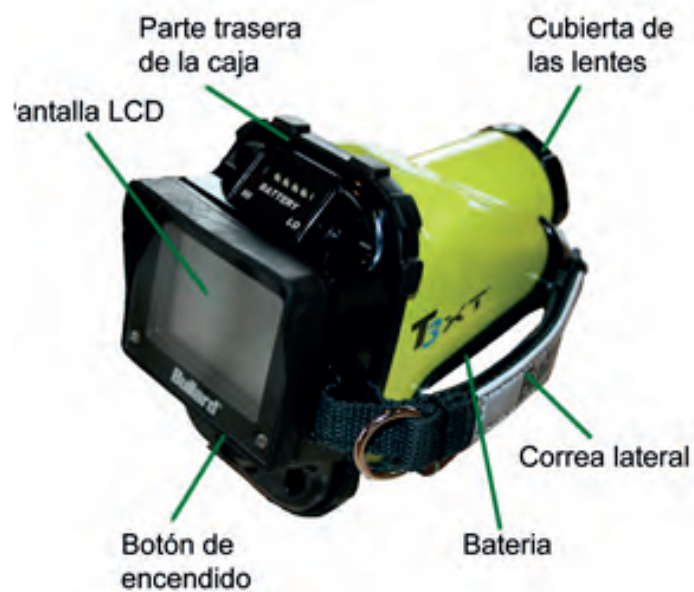
Imagen 9. Partes de la cámara termográfica Bullard de la Serie T3
