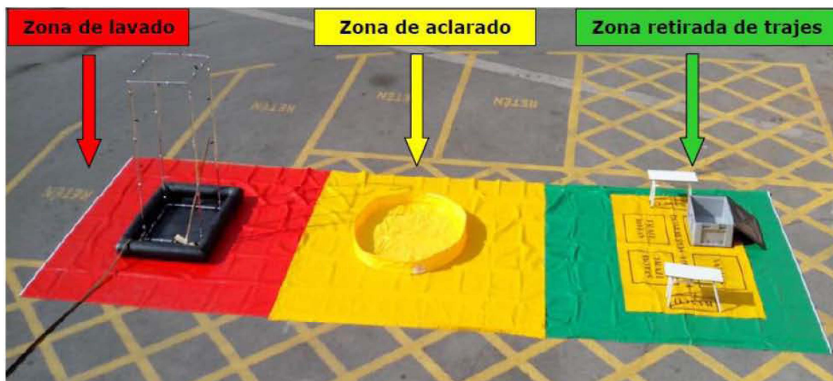
Figura 17. Corredor de descontaminación de la Unidad de Riesgo Químico.
